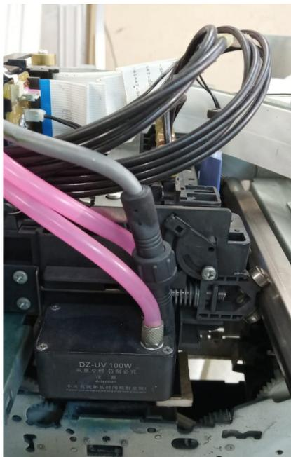
Рис. 4. Каретка печатающей головки с УФ лампой
