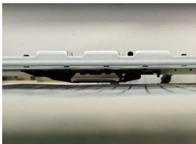
7. С помощью кнопок подъема и опускания стола добиться зазора между печатающей головкой и поверхностью ткани примерно в 2-3 мм. Для удобства можно установить линейку торцом на стол рядом с кареткой. Чем больше зазор, тем более размытым получится рисунок. Чем меньше зазор, тем больше вероятность задевания печатающей головкой запечатываемого изделия. Важно, Проверьте зазор в пяти точках стола, по углам и в середине стола, он должен быть везде одинаков.
