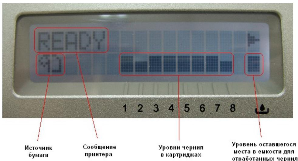
Рис. 3 Дисплей принтера
