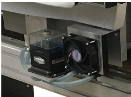
Рис. 5 Система охлаждения УФ лампы включается автоматически вместе с принтером
