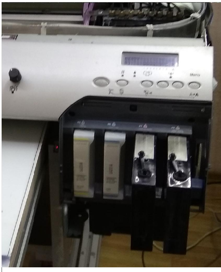
Рис. 6. Правый блок чернильных картриджей 4 канала на 2 картриджа.
