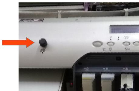
Рис. 9 Регулятор мощности УФ лампы с выключателем, при повороте вправо включает УФ лампу и при дальнейшем повороте увеличивает мощность.
